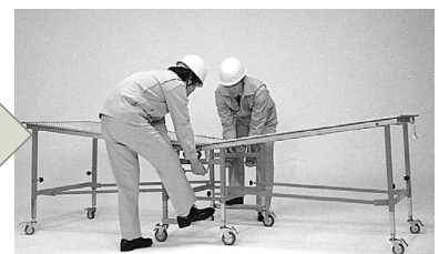
⑤中央部の取っ手を持ち、天板が水平になるように持ち上げ、ロックピンBをロックして完了です。
