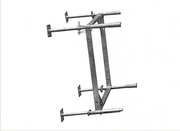
①ベースアンドヘッドフレームにベーススピンドルを差し込み、セーフティストラップで固定します。
